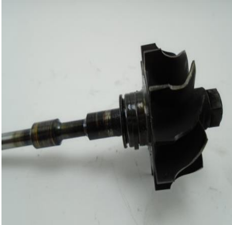
Turbina con eje gripado por contaminación y degradación del lubricante.
