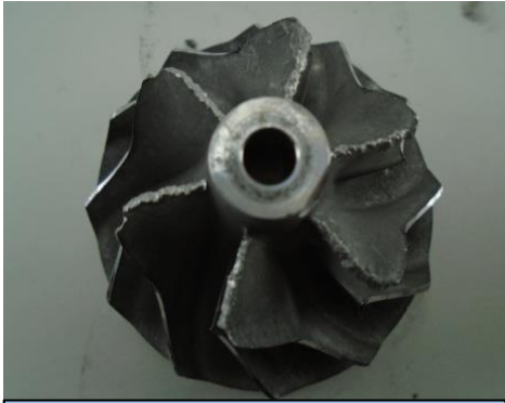
Rueda de compresora de admisión deteriorada por penetración de arenilla o similar.
