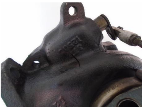
Escape agrietado por exceso de temperatura.
