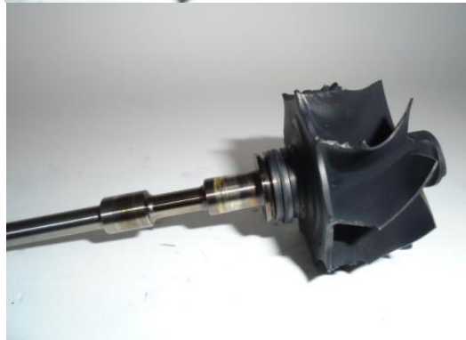
eje turbina escape dañada en alabes por golpeo de objetos.
