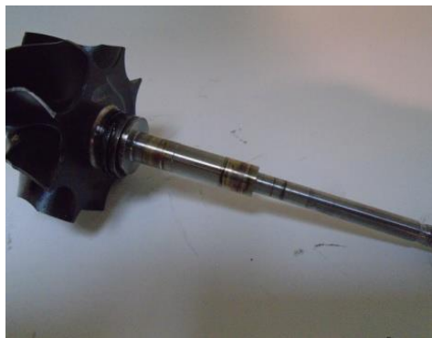
Turbina con eje gripado por falta de caudal de lubricante.
