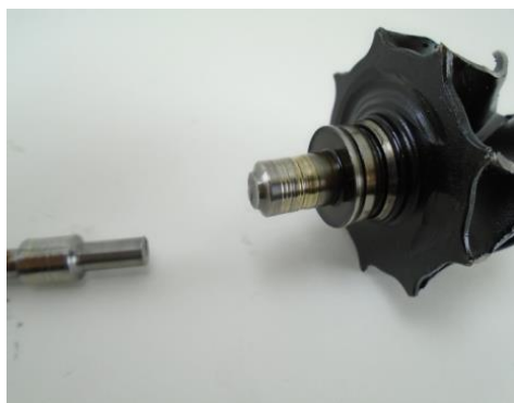
Turbina destruida por falta de presión y caudal de lubricante.
