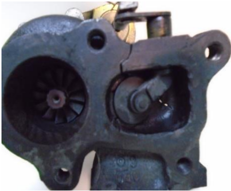
Escape agrietado por exceso de temperatura.
